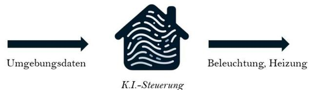
Eine autonome Gebäudesystemsteuerung kann Funktionen wie Heizung, Beleuchtung oder Sicherheitssysteme eigenständig anpassen und steuern, indem sie auf sensorisch erfasste Umgebungsdaten reagiert und entsprechende Aktionen ergreift. Für das Erfassen und Verarbeiten zeitlicher Zusammenhänge kommen Deep Learning-Architekturen wie Recurrent Neural Networks und Transformer zum Einsatz.
